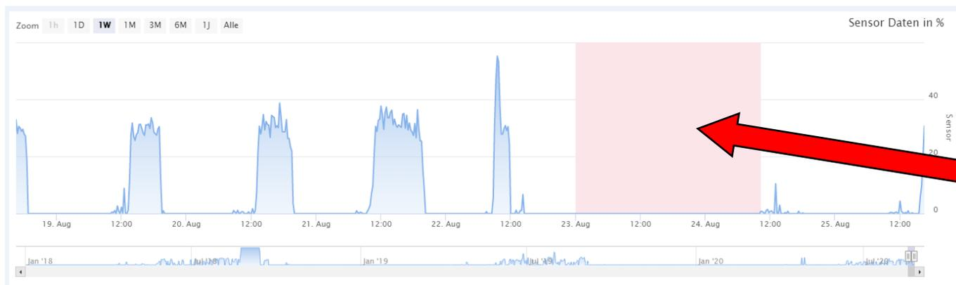
z.B. Ventilstellung muss mind. einmal pro Tag (einstellbar) ändern
